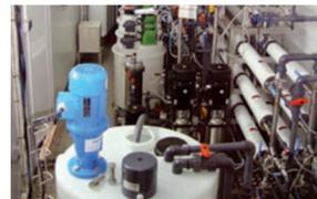
Diseño, fabricación y montaje de un equipo de osmosis inversa de doble paso para el tratamiento de las aguas de la central térmica Nairobi South (Kenia).
